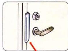
ガードプレートで ドアのこじ開け防止。
